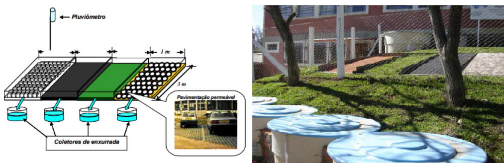
Figura 14 – Esquema com as parcelas adotadas no experimento com os 4 tipos de cobertura para análise do escoamento superficial urbano. Ao lado, a foto evidenciando o cumprimento do esquema estabelecido. Modificado de (MAUS et al., 2007).
